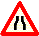
TP-17 ESTRECHAMIENTO DE CALZADA
