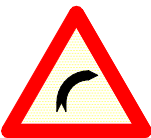
TP-13A CURVA PELIGROSA HACIA LA DERECHA
